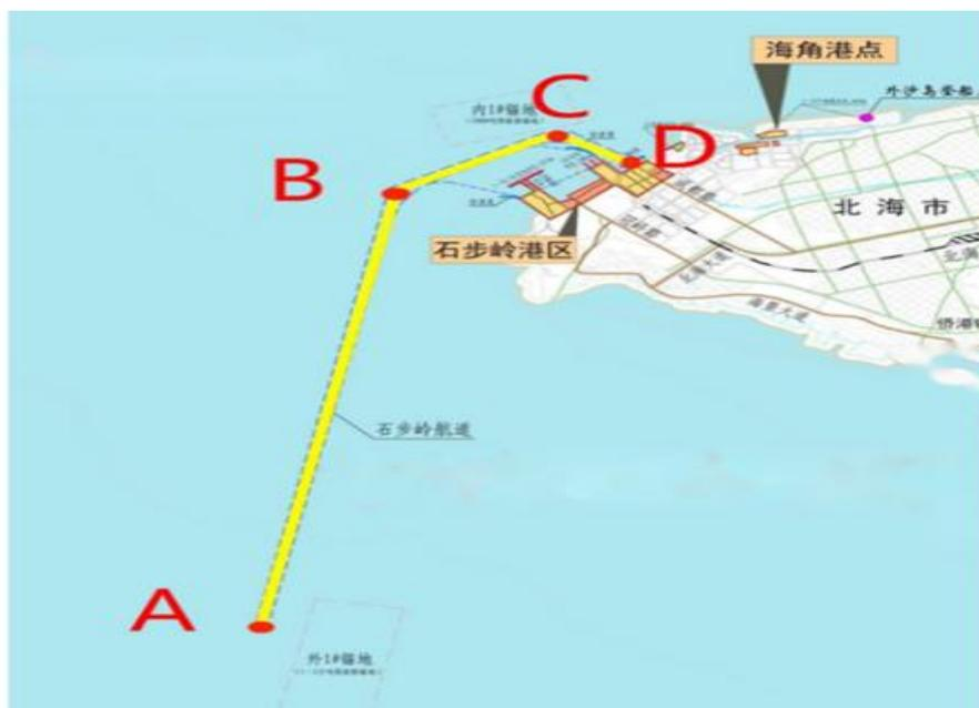
图 15 北海港石步岭港区 5 万吨级进港航道示意图
