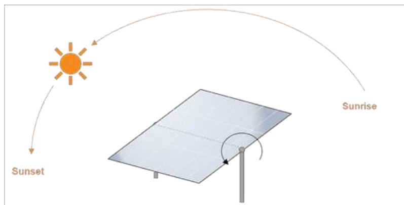
2-4-rasm. Bir o'qli kuzatuv tizimining sxematik diagrammasi
